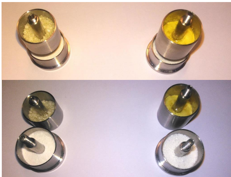
Рис. 2. Образцы ПММА, импрегнированные карбамазепином при двух температурах (75°C слева и 105°C справа) находящиеся в верхней части системы разделения исходных компонентов, а также КБЗ, находящийся в нижнем держателе системы разделения.
